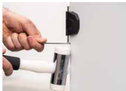
Démontage de la porte: la porte peut être facilement enlevée en retirant les pivots externes.
