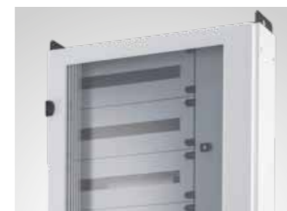
Armoire avec gaine à câbles interne: structure monobloc fabriquée en tôle soudée (épaisseur 15/10 mm) avec gaine à câbles interne pour câbles, bornier ou jeu de barres.
